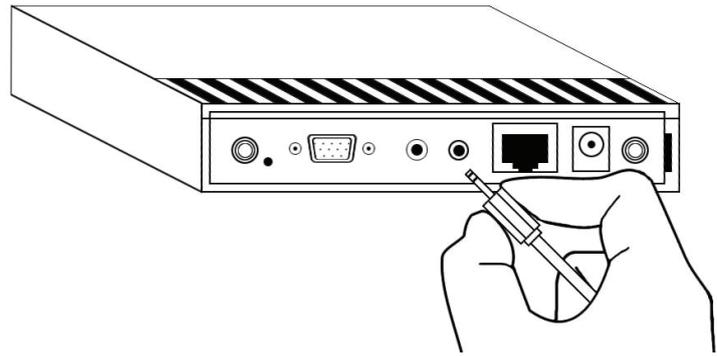
Schließen Sie das Videokabel am Videoausgang und das andere Ende am VGA-Eingang des Projektors oder Monitors an.
