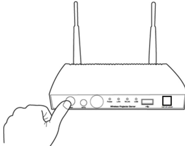
Der Projektor-Server erfragt automatisch eine IP-Adresse vom DHCP-Server auf Ihrem LAN und die IP-Adresse wird unten links im Display des angeschlossenen Projektors oder Monitors angezeigt.
