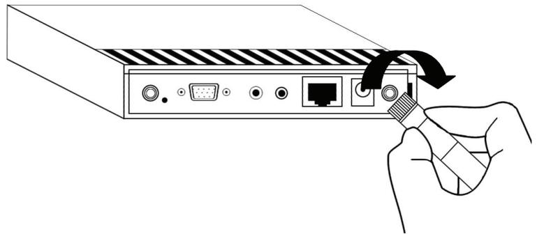
Beide Antennen müssen am Projektor-Server montiert werden.
