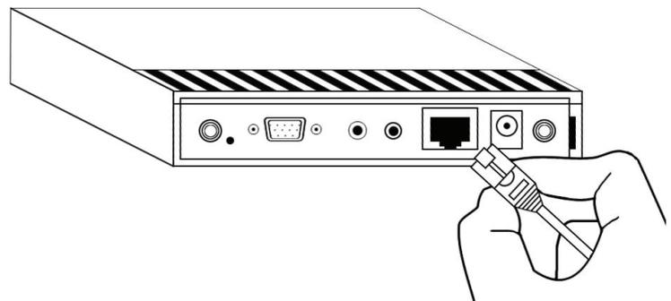
Schließen Sie die IR-Verlängerung am IR-Verlängerungsanschluss an.
